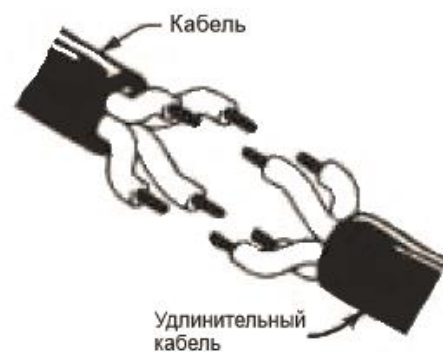
Рис.9 Если необходимо удлинить кабель, используйте добавочный кабель с большим размером сердечника, чем у кабеля, поставляемого с насосом.
