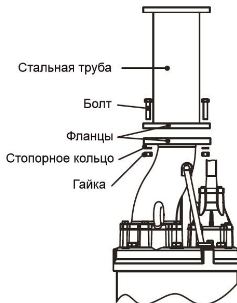
Рис.4 Установка трубы на МОДЕЛЬ2.
