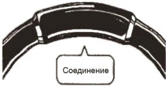
Рис.10 Чтобы предотвратить попадание воды внутрь кабеля, обязательно качественно закрепите соединение. Используйте термоусадочную муфту на клеевой основе.
