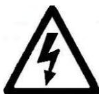
Перед снятием крышки клеммной коробки и перед каждым демонтажем агрегата/насоса необходимо полностью отключать его от напряжения питания и принять меры исключающие возможность несанкционированного или случайного повторного включения.
