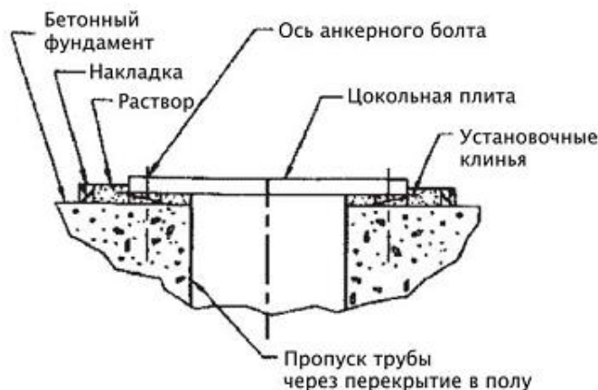
Рис. 6 Установка плиты по уровню
