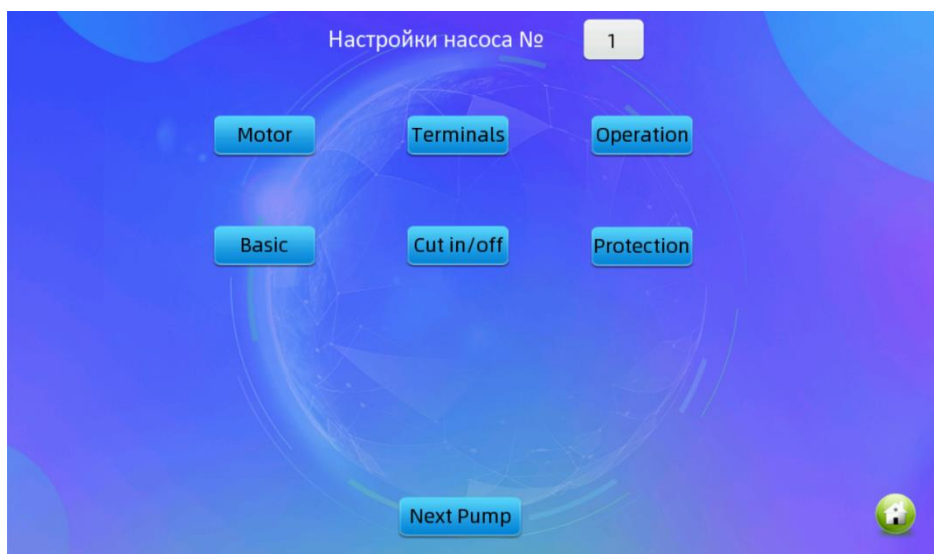
Рисунок 5 - Меню настройки преобразователей частоты
