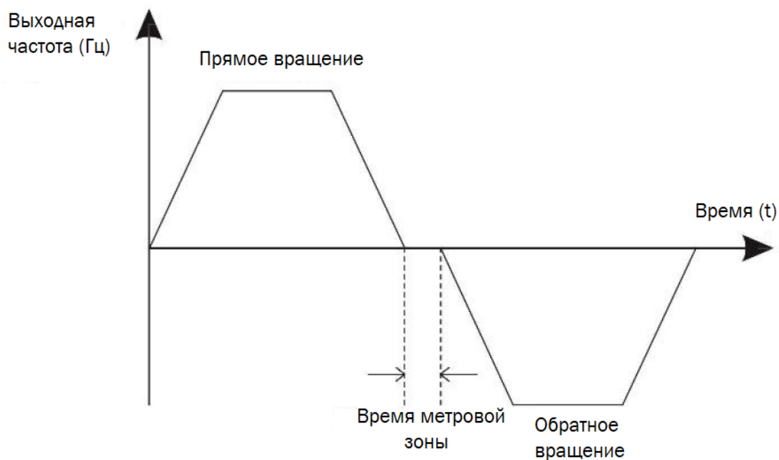
Рисунок 6-14 - Время мертвой зоны прямого/обратного вращения
